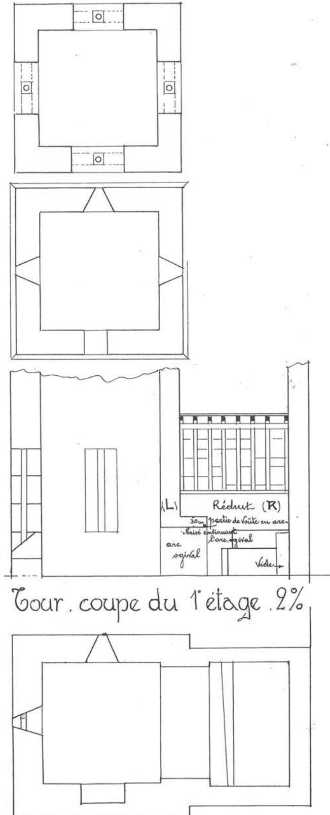
FIG. 8. — Plans des trois étages supérieurs et coupe du 1<sup>er</sup> étage de la tour.
